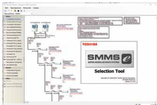
ние от последнего компонента. При выборе наружного блока учитывается неравномерность загруженности системы, положение наружного блока относительно внутренних, длина магистральной трубы. К полученной системе Вы можете добавить центральный пульт управления и/или систему сетевого управления.
