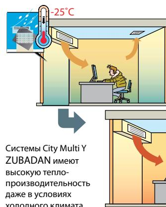
Производительность обычных кондиционеров снижается почти вдвое при низкой наружной температуре.
