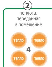
Принцип получения тепла с помощью теплового насоса отличается от традиционных систем нагрева, основанных на сжигании газа или жидкого топлива, а также прямого преобразования электрической энергии в тепловую. В таких системах единица энергии энергоносителя преобразуется в неполную единицу тепловой энергии. В то время как тепловой насос, затрачивая единицу
